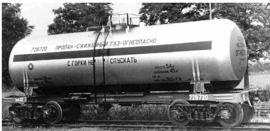
Cysterna 903Rb na skroplony propan-butan produkowana w latach 1978-1981 – z archiwum S. Kosa
