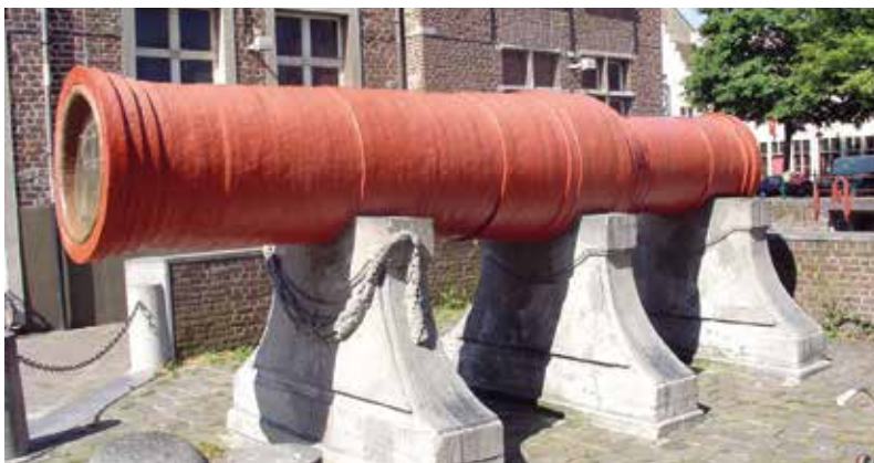
Burgundzka bombardra „De dulle Griet” – następczyni „Mons Meg”, odlana w połowie XV w., miała wagę 16,4 t i kaliber 640 mm. Strzelała pociskami kamiennymi o wadze ok. 300 kg. Dziś eksponowana w Gandawie – źr. ilustracji: Wikipedia
